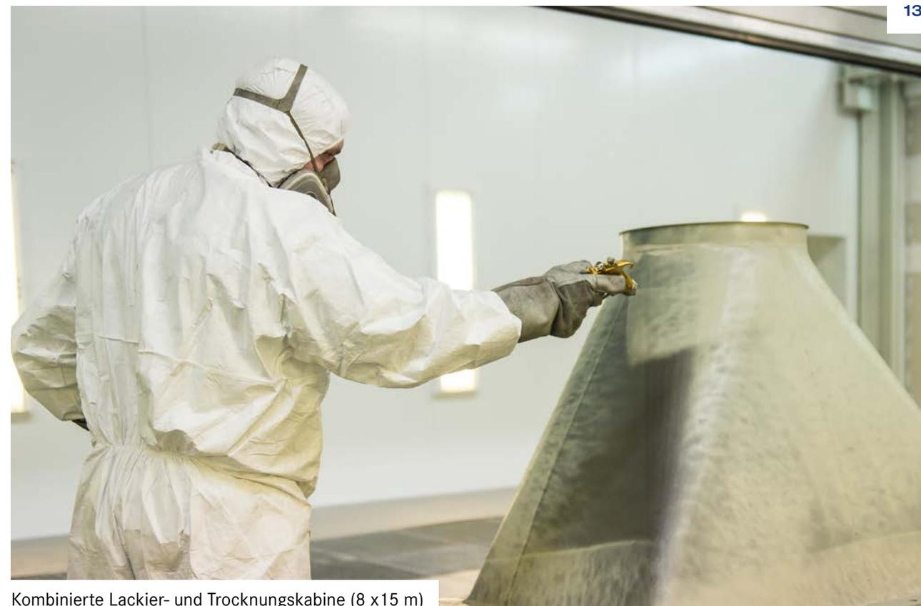
Kombinierte Lackier- und Trocknungskabine (8 x 15 m)
