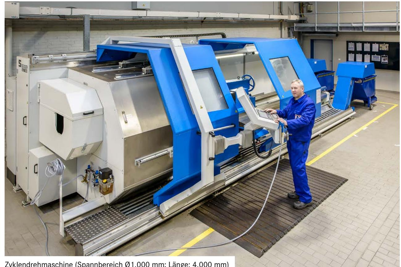
Zyklendrehmaschine (Spannbereich Ø1.000 mm; Länge: 4.000 mm)
